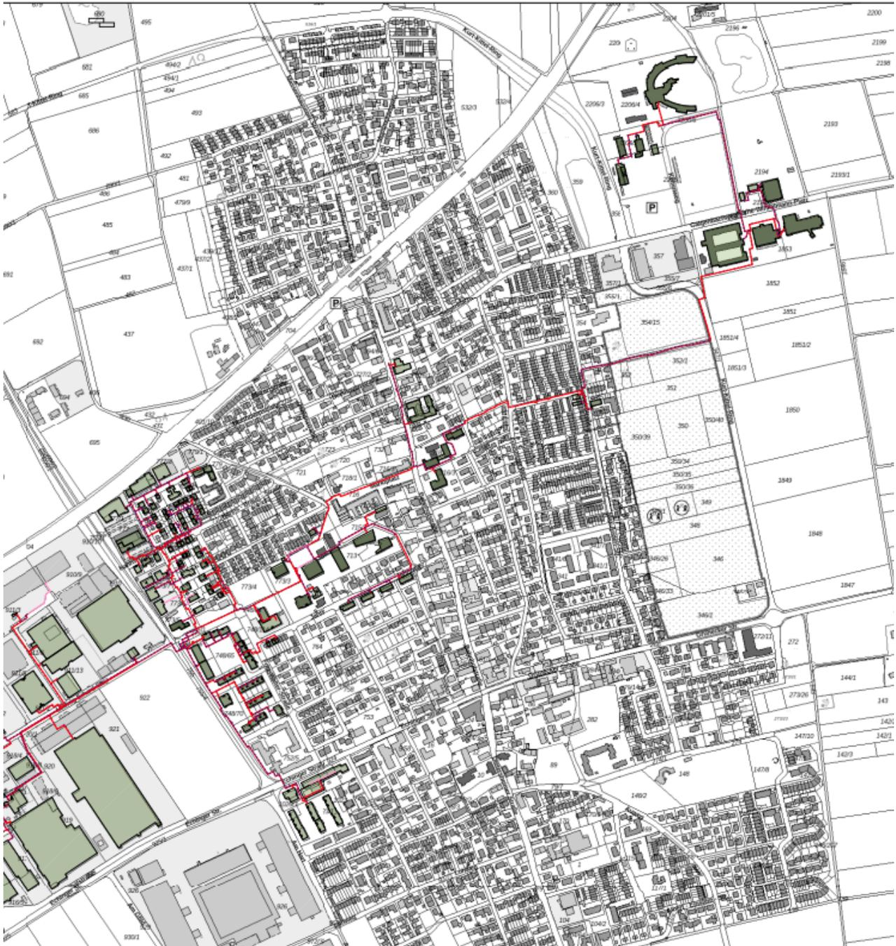
**Abbildung 37 Bestandswärmenetz (Fernwärme) Neufahrn**
