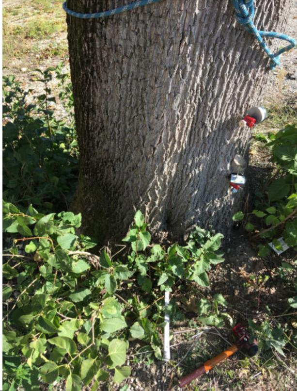
Am Stammfuß der untersuchten Bäume (hier im Bild Ahorn-Nr. 1) wurden Kippwinkelsensoren angebracht. Es wurden immer 2 Sensoren angebracht, um die erzeugten Messwerte abzusichern.
