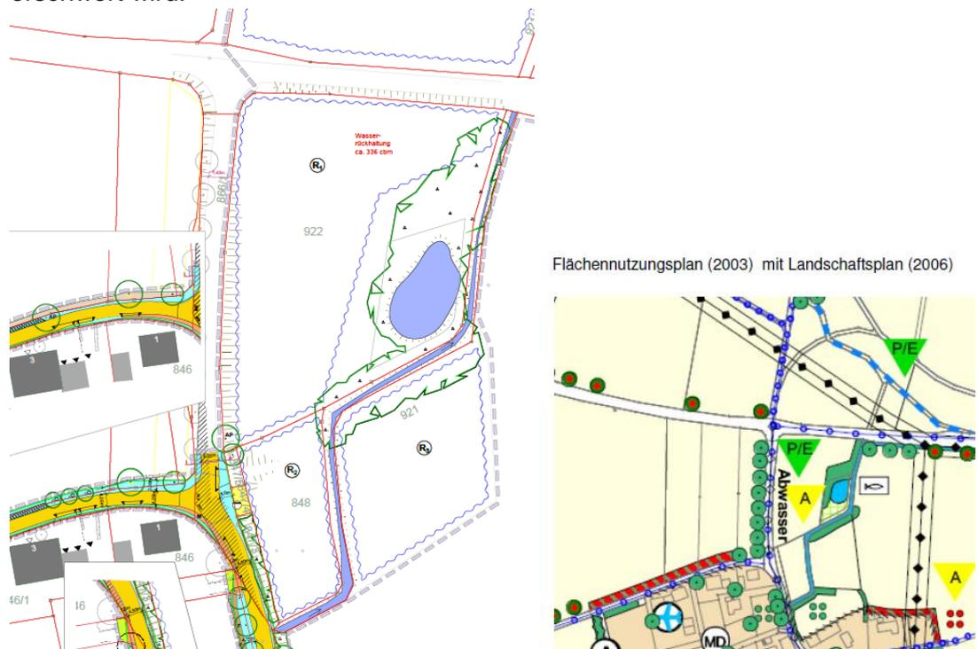
Abb. 10 Alternativer Standort Regenrückhaltebecken auf Fl. Nr. 922 Gemarkung Massenhausen (Planungsstand frühzeitige Beteiligung 2012), ohne Maßstab
